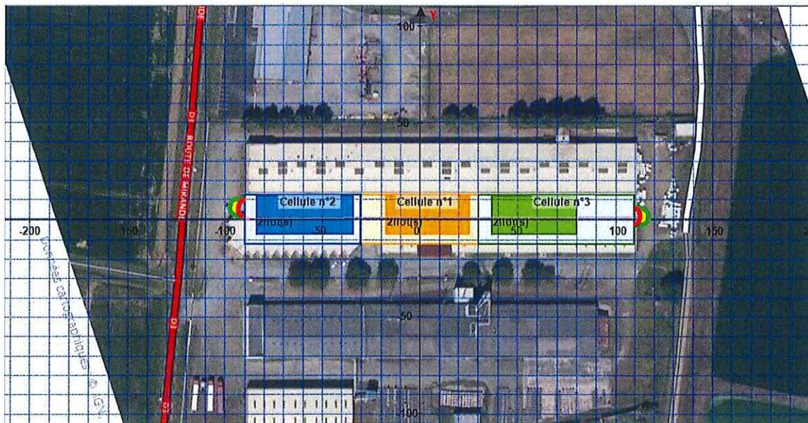
Figure 9 : Zones d'effet des flux thermiques – Scénario Zone 2
