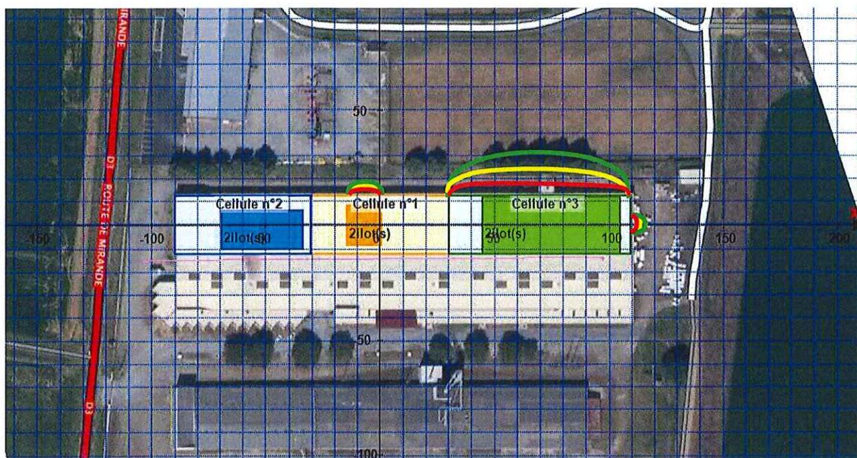
Figure 10 : Zones d'effet des flux thermiques – Scénario Zone 1
